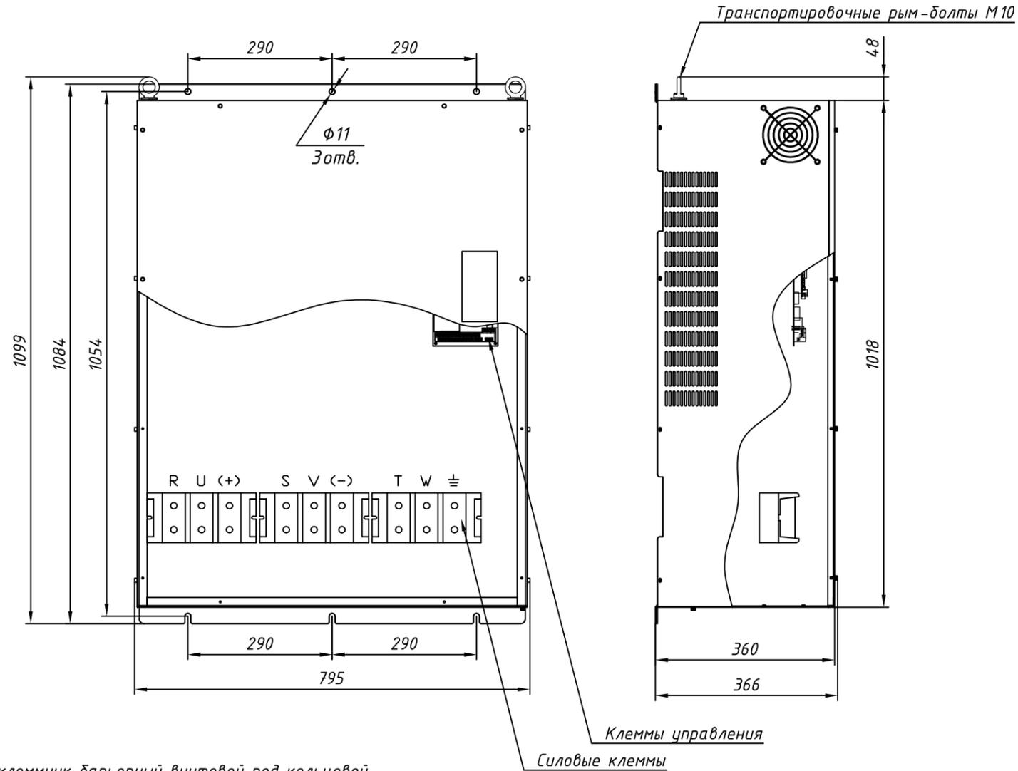
1. Силовые клеммы представляют из себя клеммник барьерный винтовой под кольцевой наконечник φ10.
